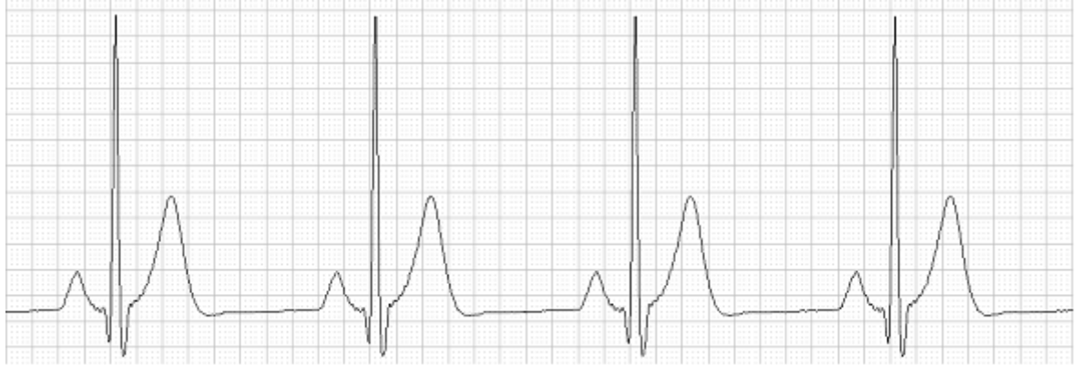
Figura 54. Ejemplo de la misma señal con filtro de línea para 50Hz
